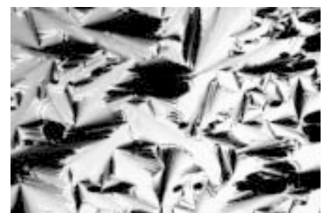
Die Fächertextur eines Flüssigkristalls unter dem Polarisationsmikroskop
